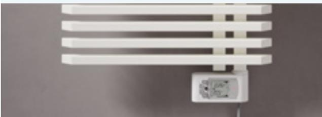
Resistenza elettrica ad innesto tramite fastom con controllo elettronico per regolare la temperatura ambiente. Classe di isolamento II. Grado di protezione IP44. L'elettronica è fornita in colore Bianco Standard (cod. 01) per radiatori bianchi; cromata per radiatori colorati.
