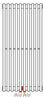
Allacciamenti idraulici saldati passo 50 mm
