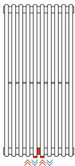
Allacciamenti idraulici saldati passo 50 mm
