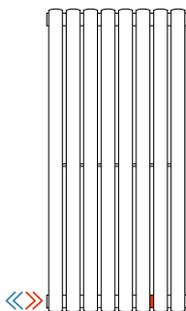
Allacciamento solo per impianto modul e/o bitubo (unicamente con sonda dn 11 mm)
