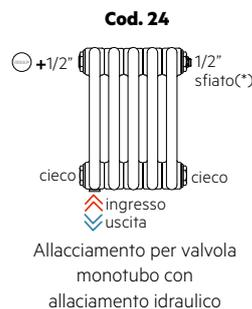
**Allacciamento monotubo VERTICALE con allacciamento idraulico saldato Cod. 24**
