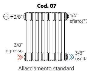
Per batterie TESI con altezza superiore a 1000 mm o per batterie con meno di 15 elementi inserire diaframma sul lato ingresso acqua. Vedi allacciamenti riportati sotto cod. 08, 09, 10, 11.
